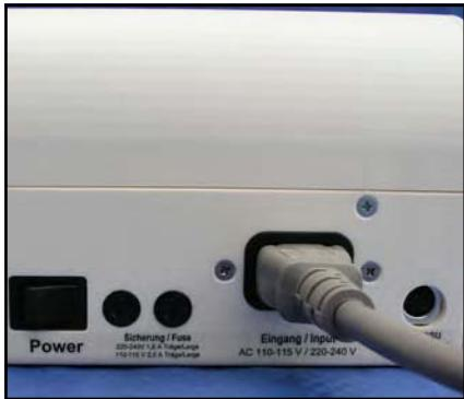
Bevor das Netzkabel angeschlossen wird, muss überprüft werden, ob die Netzspannung auf den landesüblichen Wert eingestellt ist. Sollte dies nicht der Fall sein, muss der Netzspannungsschalter mit einem Schraubendreher oder einer kleinen Münze auf die landesübliche Netzspannung umgeschaltet werden (14).
