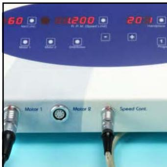
**Grundsätzlich müssen Kabelknicke vermieden werden. Der Fußregler muss eben auf dem Boden stehen, da sonst die zur Bedienung notwendige Stabilität und Sicherheit nicht gewährleistet ist.**
