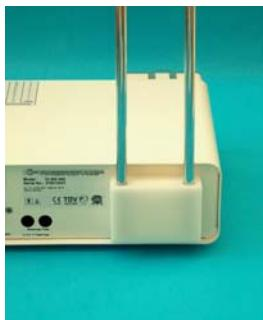
**Die Stativstangen für den Mikromotor (20) und den Behälter mit der Kühlflüssigkeit( 19) werden in die Vorrichtung auf der Geräterückseite gesteckt (17).**
