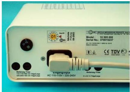
**Bevor das Netzkabel angeschlossen wird, muss überprüft werden, ob die Netzspannung auf den landesüblichen Wert eingestellt ist. Sollte dies nicht der Fall sein, muss der Netzspannungsschalter mit einem Schraubendreher oder einer kleinen Münze auf die landesübliche Netzspannung umgeschaltet werden (15).**
